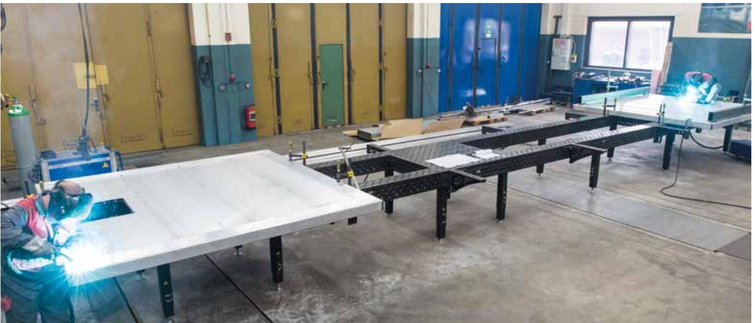
*Die Einzelteile einer Heckklappe für einen Sattelaufleger Rollbandwagen werden geheftet und verschweisst.*
