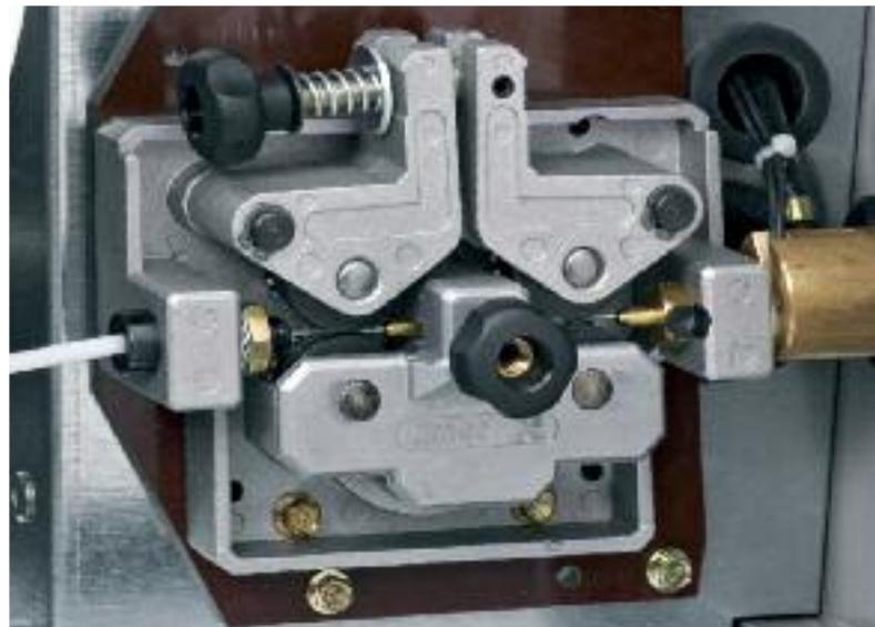
*Kraftvoller 4-Rollen-Antrieb für Feinschweißarbeiten an Dünoblech*
