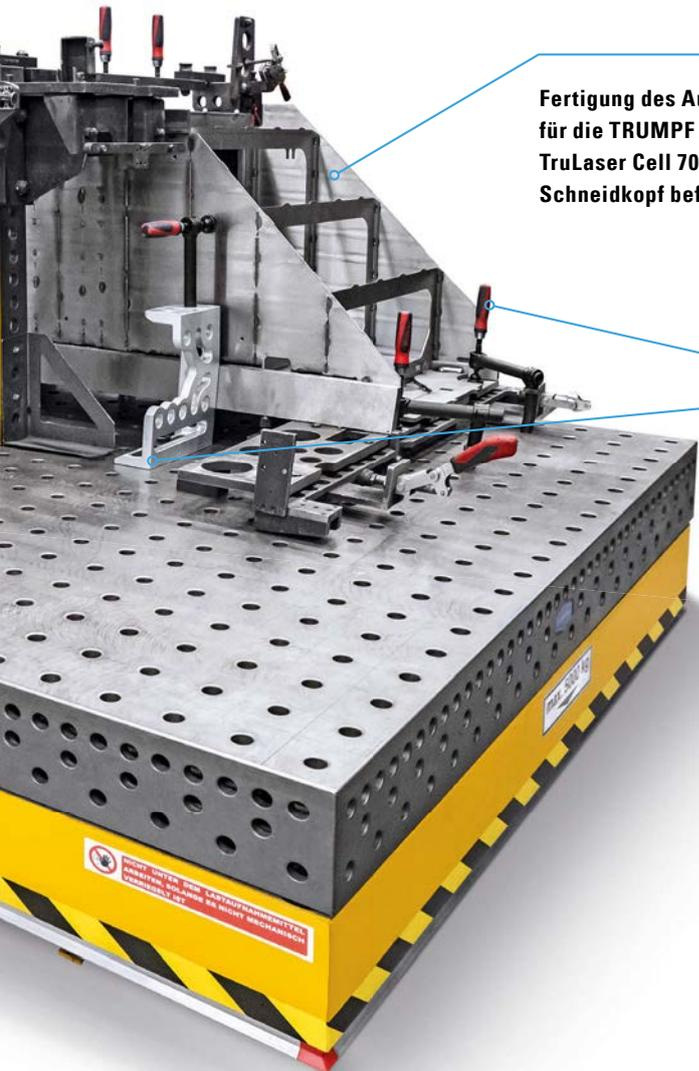
Fertigung des Auslegers mit Y-Achse für die TRUMPF 3D Laserschneidanlage TruLaser Cell 7040, an der die Z-Achse mit Schneidkopf befestigt wird
