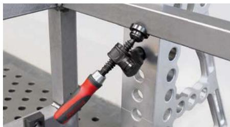
**Positionsgenaueres Spannen.** Auch beim Schrägspannen von Werkstücken bietet die Performance-Schraubzwinde stets festen Halt. Stufenlos schwenkbar und  $360^\circ$  drehbar passt sie sich jeder Spannsituation an.
