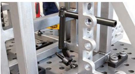
**Enge Platzverhältnisse.** Die DEMMELER Performance-Schraubzwinde ermöglicht einfaches Spannen auch an schwer zugänglichen Stellen. Dabei sorgt der Druckteller mit Prisma für eine zentrische Kräfteverteilung.
