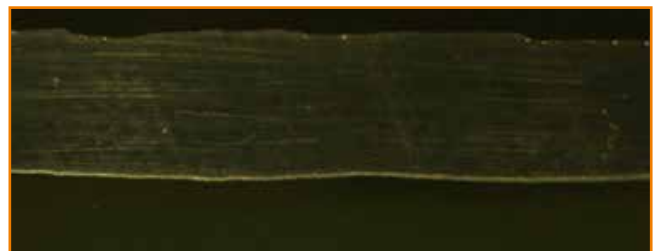
Reparaturschweißung mit DualWave geschweißt. Deutlich weniger Poren.
